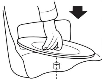
4. Platzieren Sie die Feuerlöschplatte auf die richtige Position über der Distanzscheibe und stellen Sie sicher, dass die Platte ordnungsgemäß ausgerichtet ist.
